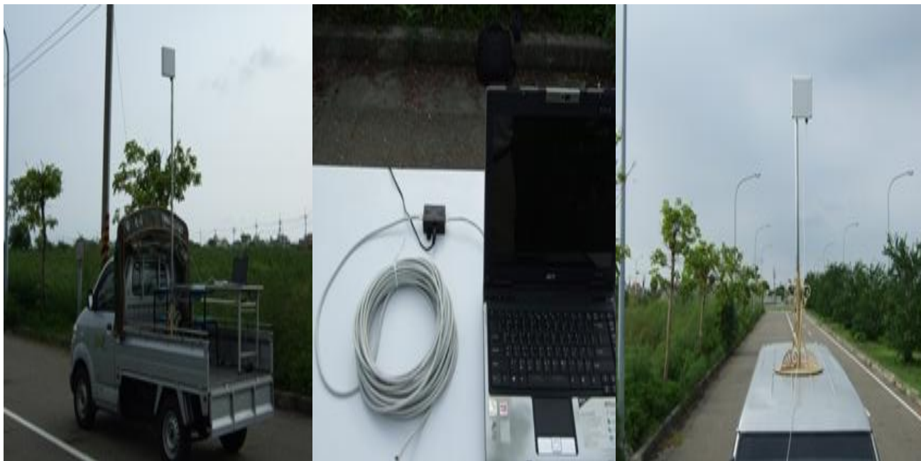
圖一三：14dBi 指向易天納天線 CPE
